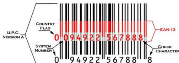
Gambar 8: UPC dan EAN yang ekuivalen
